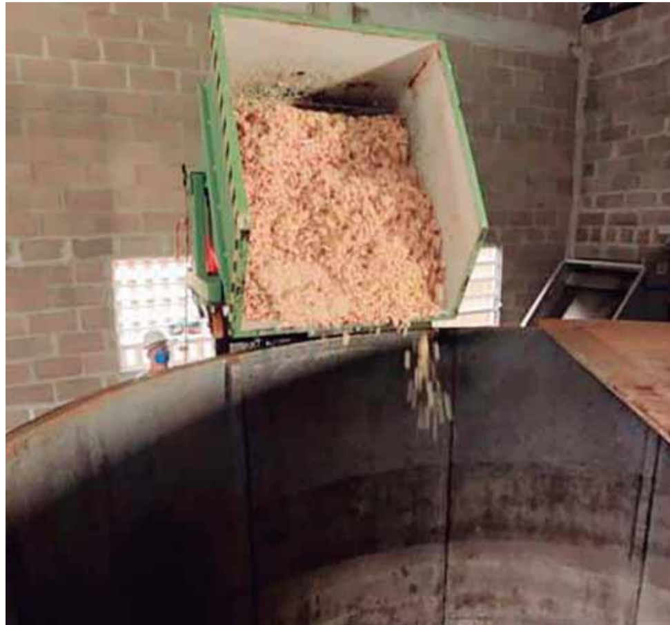
Usina usa mistura de esgoto, poda de grama e alimentos descartados por restaurantes como matéria-prima na produção de biometano
